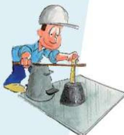
3. Una vez lleno el cono, enrase la parte superior y limpie el hormigón derramado en la plancha base. Levante el cono verticalmente con cuidado y colóquelo al lado del hormigón moldeado.
