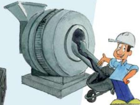
Separe en una carretilla una cantidad conveniente de hormigón de la betonera, al comenzar la descarga, en la mitad y a su término. La muestra se revuelve en la carretilla para homogeneizarla. Debe sacarse una muestra por cada 50 m<sup>3</sup> del hormigón, con un mínimo de 3 muestras para la obra.
