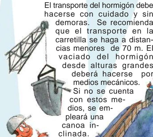
El transporte del hormigón debe hacerse con cuidado y sin demoras. Se recomienda que el transporte en la carretilla se haga a distancias menores de 70 m. El vaciado del hormigón desde alturas grandes deberá hacerse por medios mecánicos. Si no se cuenta con estos medios, se empleará una canoa inclinada.
