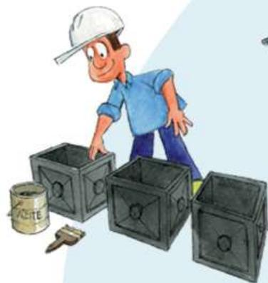
Se dispondrá para cada muestra de un mínimo de 3 moldes. Revise que estén en buenas condiciones y correctamente armados. Acéitelos interiormente con una película delgada. Los moldes cúbicos deben ser de 20 ó 15 cm. de arista, de placas fundidas o planchas de acero de 10 mm. de espesor como mínimo. La calidad de los moldes debe verificarla el laboratorio.
