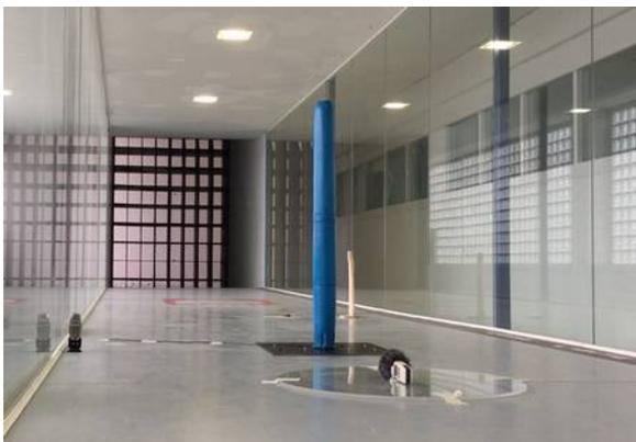
Figura 8. Ensayo en el túnel Aclal6 del CIDA (IDR/UPM) de un modelo de 1m de altura, diámetro máximo del mástil de 95mm sustentado por una varilla de fibra de carbono, circular, pultrusionada y maciza de 10mm de diámetro. (Febrero 2018).
