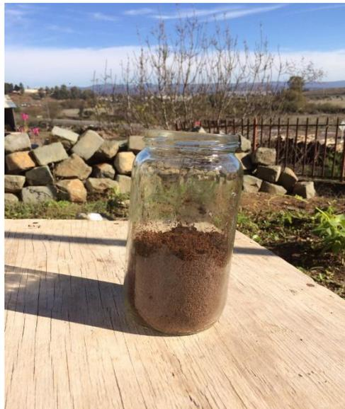
*Ilustración 38: Prueba de Granulometría. Fuente: Elaboración propia.*
