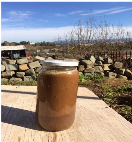
*Ilustración 39: Prueba de granulometría. Fuente: Elaboración Propia.*
