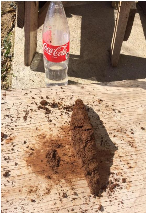
*Ilustración 41: Prueba de plasticidad. Fuente: Elaboración Propia.*
