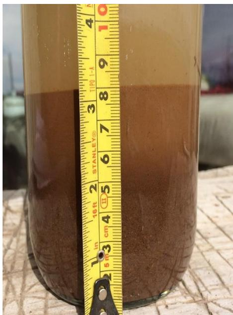
*Ilustración 40: Prueba de granulometría. Fuente: Elaboración propia.*
