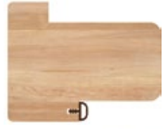
Marco T para puerta de abatir (espesor 44/54 mm) con mampara o puerta fija
