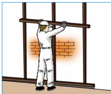
Fig. 10. Por último con una mira apretada contra otras dos se consiguen maestras del mismo espesor
