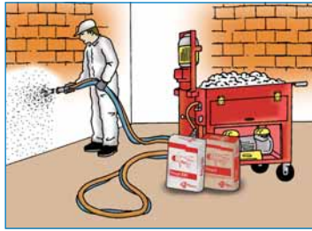
Fig. 16. Proyección en paramentos verticales
