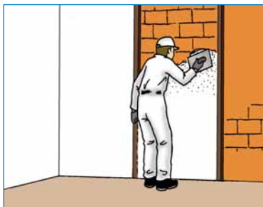
Fig. 11. Tendido del yeso entre miras
