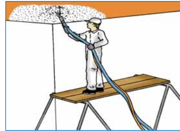
Fig. 17. Proyección en paramentos horizontales
